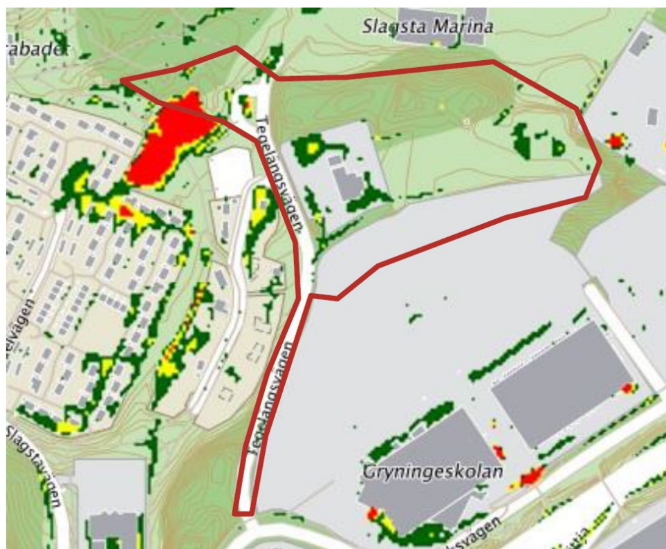
Figur 14: Skyfallskartering med beräknade maximala vattendjup vid 100-årsregn (rött >0,5 m, gult 0,3-0,5 m, grönt 0,1-0,3 m) och skiss över planområdesgränser i rött
