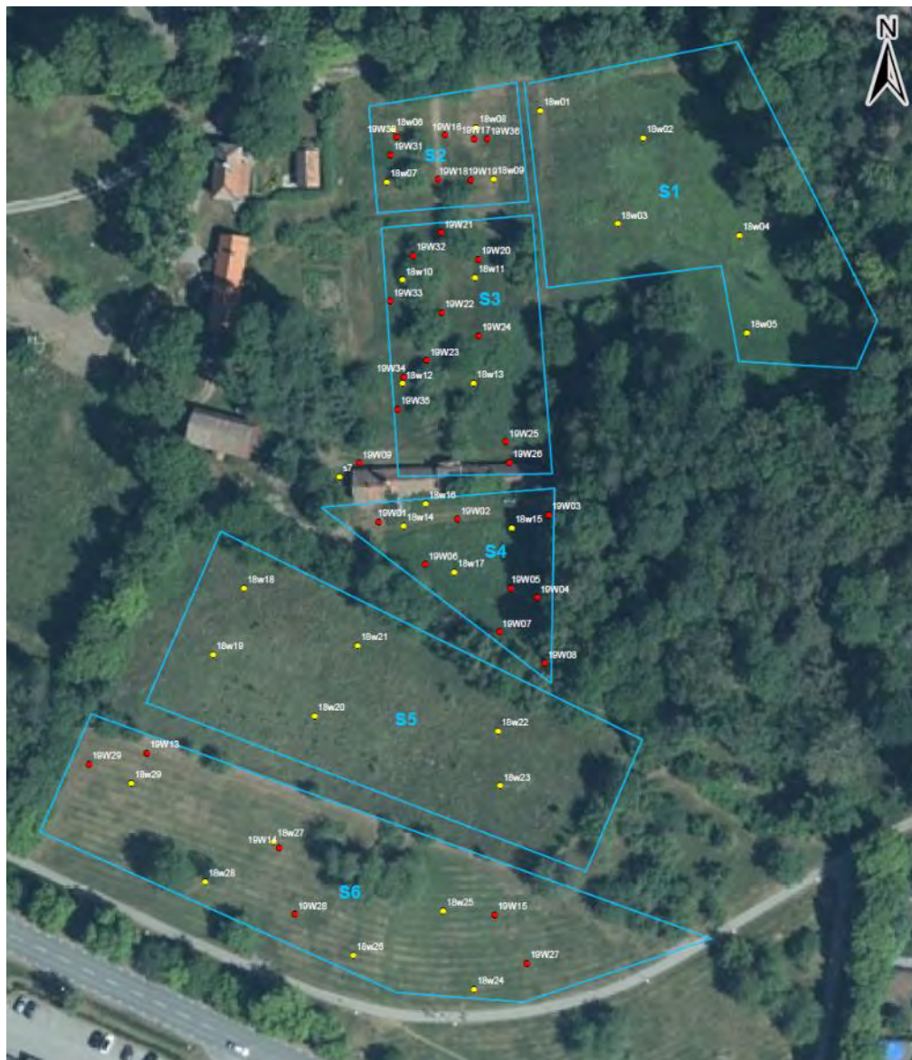
Bild 8: Provpunkter och provtagningsområden där förekomsten av markföroreningar undersöktes under 2018 (gula prickar) och kompletterande provtagningar som genomfördes 2019–2020 (röda prickar).
