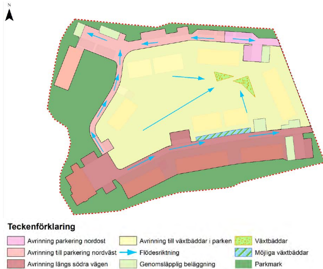
Bild 7. Illustration över dagvattenlösning/växtbäddar (Geosigma).
