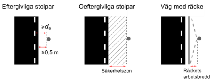
Figur x: Vänster: Eftergivliga stolpar ska placeras på ett avstånd \geq d_e från körbanekant, enligt Tabell x, och om möjligt minst 0,5 m från beläggningkant. Mitten: Oeftergivliga stolpar ska placeras utanför säkerhetszonen 5 . Höger: Om vägen har räcken ska stolpar placeras bakom räcke och utanför räckets arbetsbredd.
