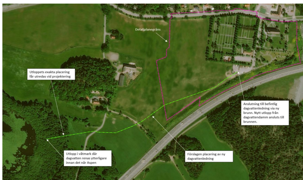
Översiktlig principskiss över planerad dag- och dränvattenavledning till sjön Aspen. Utdrag från dag- och dränvattenutredning (Bjerking, 2022-06-03)
