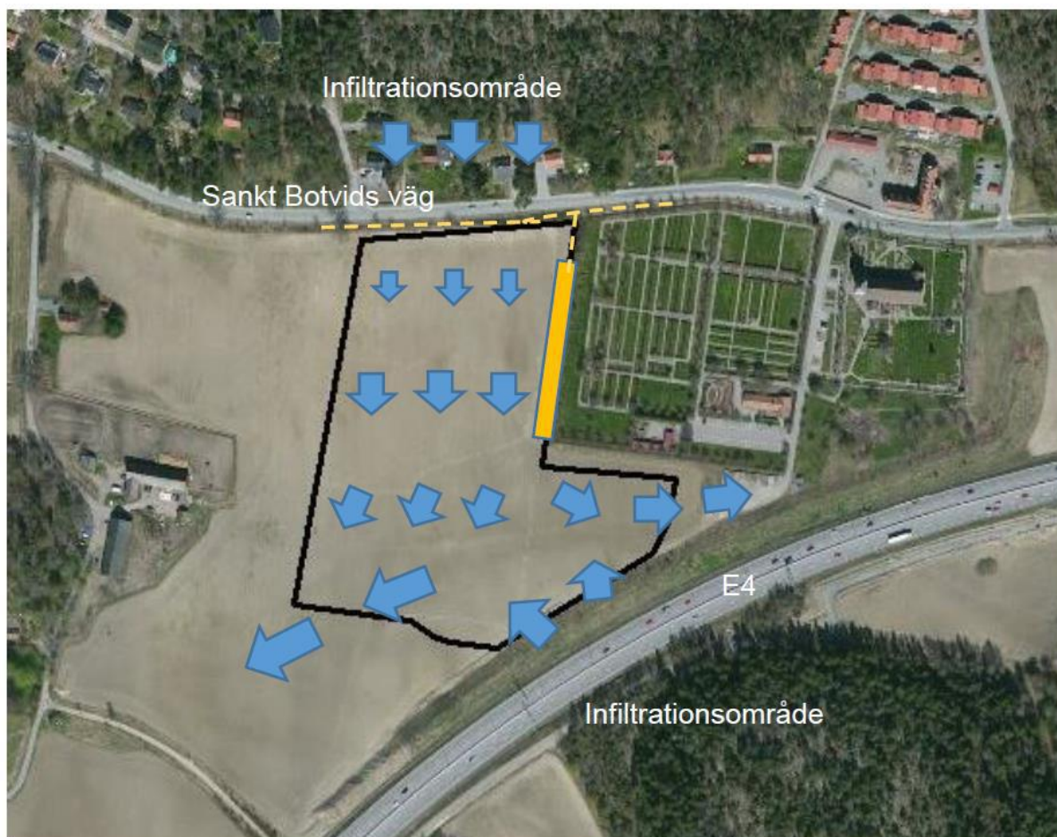
Figur 30. Grundvattenströmningsriktning av grundvattnet i friktionsjorden (blå pilar) vägdike längs S:t Botvids väg (gul streckad linje) och "stenkistan" (gul rektangel). Illustration ur PM Hydrogeologi, Bjerking 2016-08-17.
