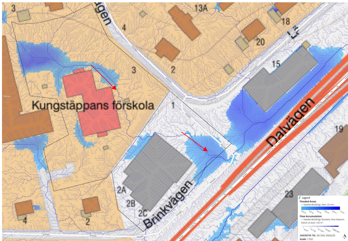
Figur 5. Rinnvägar samt områden med risk för instängt dagvatten. Utredningsområdet markerat med svart och avrinningsområdets utloppspunkter markerade med röda pilar (SCALGO Live). Ljusblå områden visar instängda områden.
