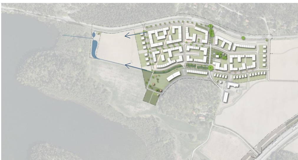
Figur 2. Illustrationsplan, tänkt bebyggelse och placering av dammar. Observera att bebyggelsen har ändrats något efter att figuren färdigställdes, se figur 3.
