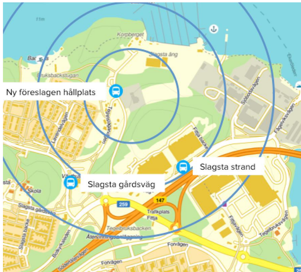
Figur 32 Planområdet för Slagsta strand med de två närmaste busshållplatserna, samt en ny föreslagen hållplats. Cirklar visar avstånd fågelvägen för 200, 400 och 600 meter. Källa TUB
