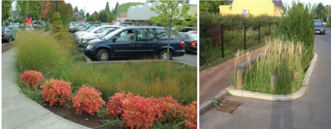
Figur 18. Exempel på nedsänkta växtbäddar i anslutning till allmän platsmark (Bildkälla: Stockholm stad och WRS)
