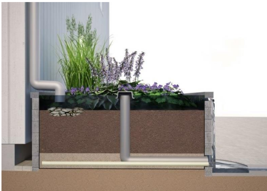
Figur 16. Principskiss för växtbädd i upplyft konstruktion. (Bildkälla: Grågröna systemlösningar för hållbara städer, Inventering av dagvattenlösningar för urbana miljöer, Vinnova 2014.)
