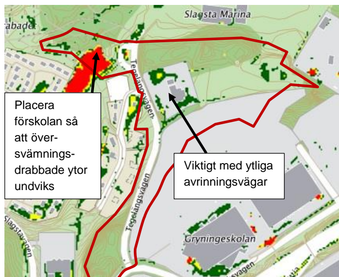
Figur 25. Skyfallskartering (utdrag ur Botkyrka kommuns webbkarta 2017-09-25) med beräknade maximala vattendjup vid 100-årsregn (rött >0,5 m, gult 0,3-0,5 m, grönt 0,1-0,3 m) och skiss över planområdesgränser i rött
