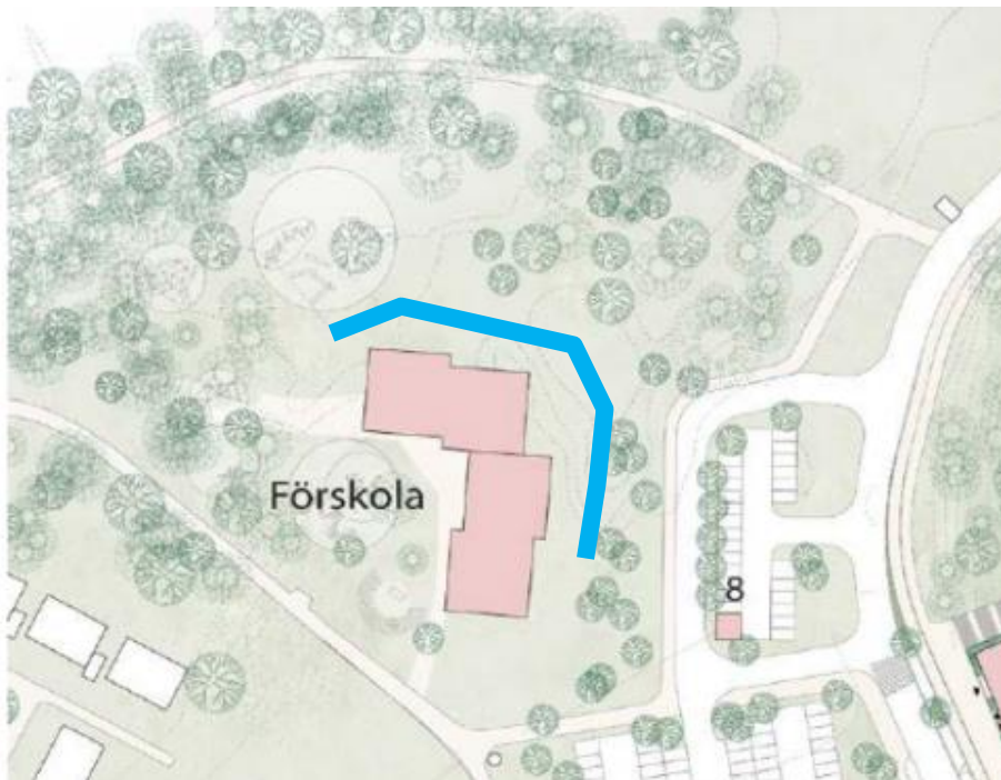
Figur 12. Skiss över ungefärlig längd på svackdike som föreslås för förskolan.
