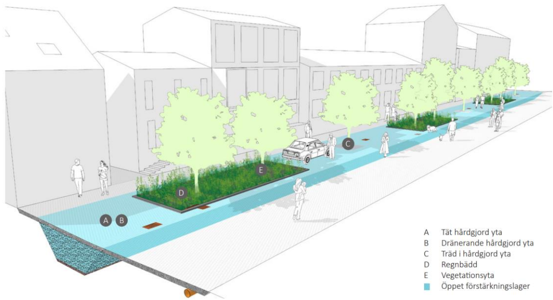
Figur 10. Exempel på gaturum med BGG-system förlagd i flexzon. Det blå området symboliserar ett öppet förstärkningslager som här ligger i ett stråk utmed hela gatan. På markytan varvas hårdgjorda ytor med regnbäddar, vegetationsytor och träd på valfritt sätt. (Edge, 2019)
