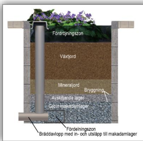
Figur 7. Exempel på uppbyggnad av regnbädd med tjockt lager växtjord för att möjliggöra plantering av träd. Vid hög vattenbelastning bräddas vatten ut i kupaBrun (Movium 2015)
