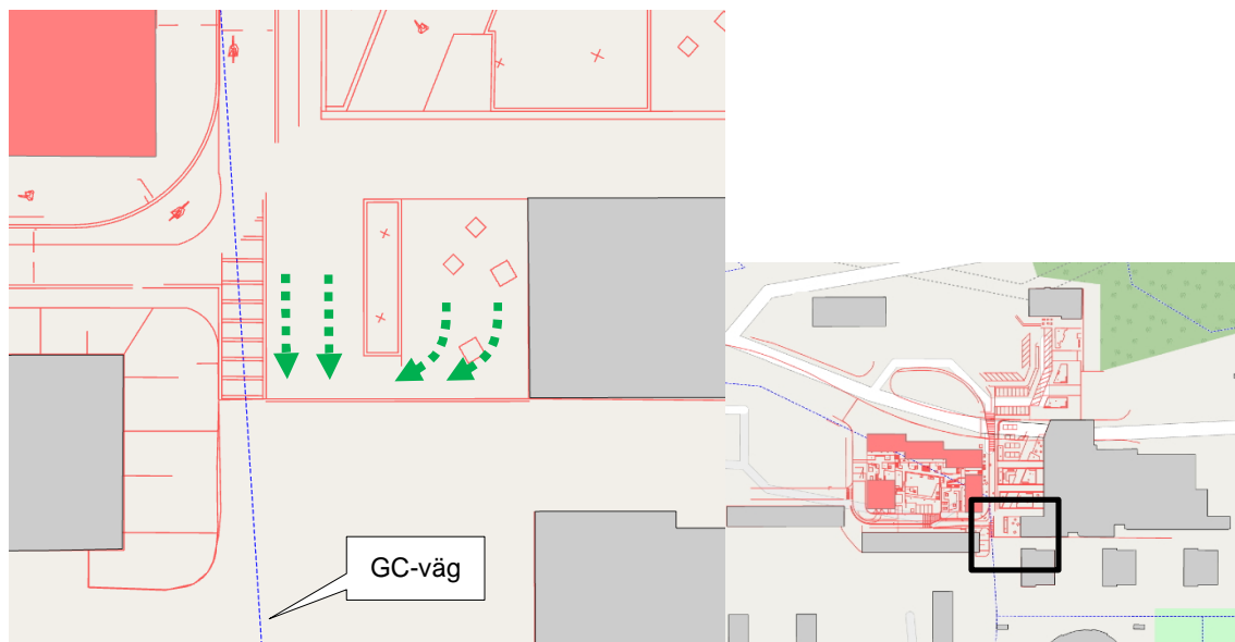
Figur 8. Gröna pilar visar schematiskt hur lutning av torgets södra kant utformas för att styra vatten mot befintlig gång- och cykelväg.
