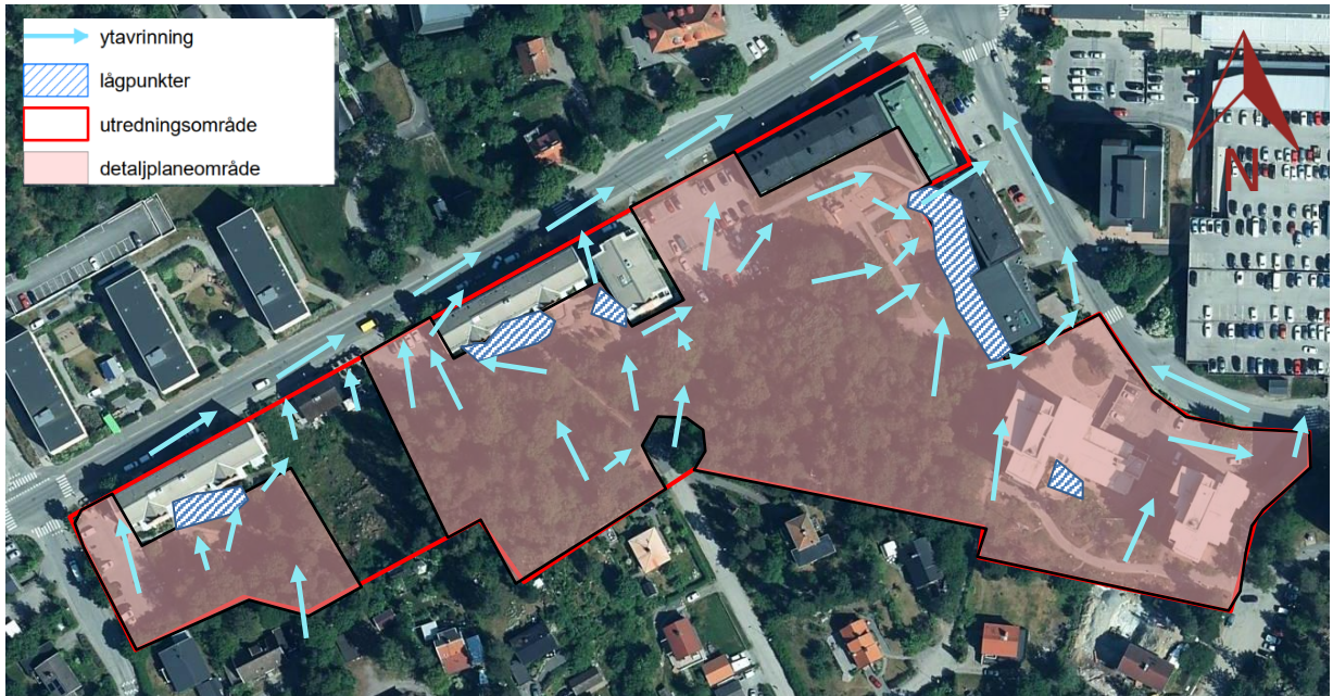
Figur 6. Ytlig avrinning inom utredningsområdet. Instängda området med översvämningsrisk, enligt Botkyrka kommuns skyfallsmodell, förekommer inom och i direkt anslutning till utredningsområdet. Utredningsområdets östra del avrinner mot Gröndalsvägen via lägpunkt längs med husfasad. Övrigt utredningsområde avrinner mot Grödingevägen.
