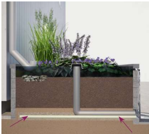
Figur 16: Nedsänkt respektive upphöjd regnbädd med översvämningsskydd, bräddavlopp och dränering.
