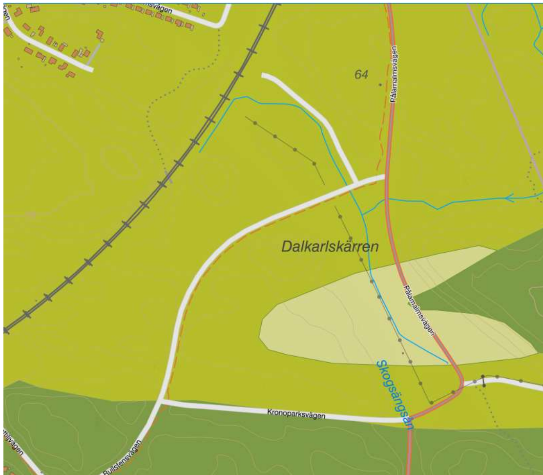
Figur 5. Bergskvalitetskartan avseende ballast för väg/järnväg. Klass 1 är det mörkaste gröna längst ner samt till höger, därefter mellangrönt klass 2 samt det ljusaste gröna i mitten klass 3. Källa: sgu.se.
