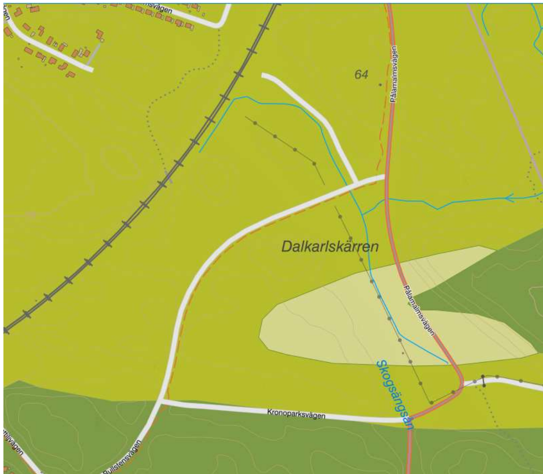
Figur 6. Bergkvalitetskarta avseende ballast för väg/järnväg. Klass 1 är det mörkaste gröna längst ner samt till höger, därefter mellangrönt klass 2 samt det ljusaste gröna i mitten klass 3. Källa: sgu.se.
