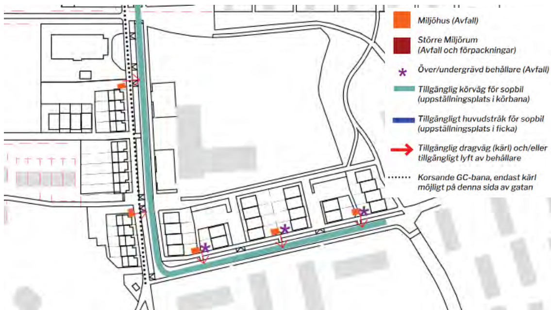
Figur 28. Plats för avfall, körvägar samt tillgängliga dragvägar. Rosa cirklar visar 50 meter avstånd från bostadscentré.
