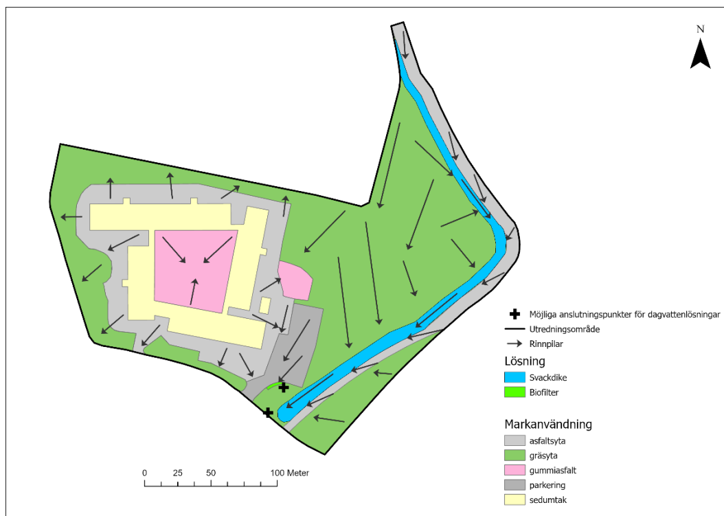
Figur 6-5 Avvattningsplan för planerad situation inom planområdet med rinnpipilar, lösningsförslag och möjliga anslutningspunkter i befintligt ledningsnät för föreslagna lösningar.
