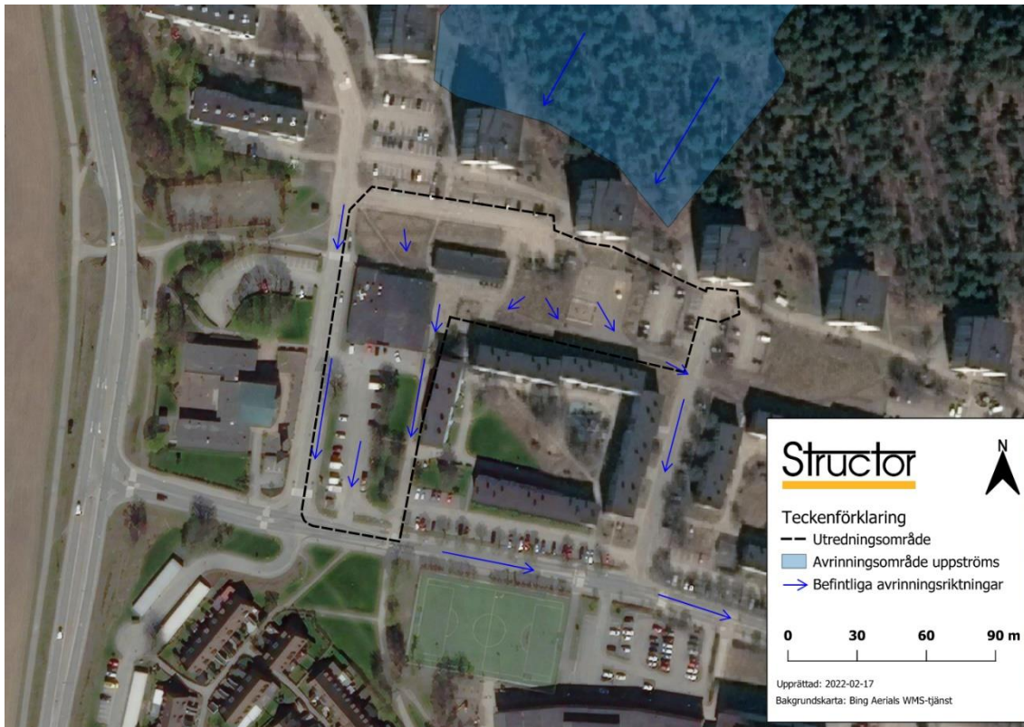
Figur 4-7. Befintliga ytliga avrinningsvägar inom och omkring utredningsområdet.
