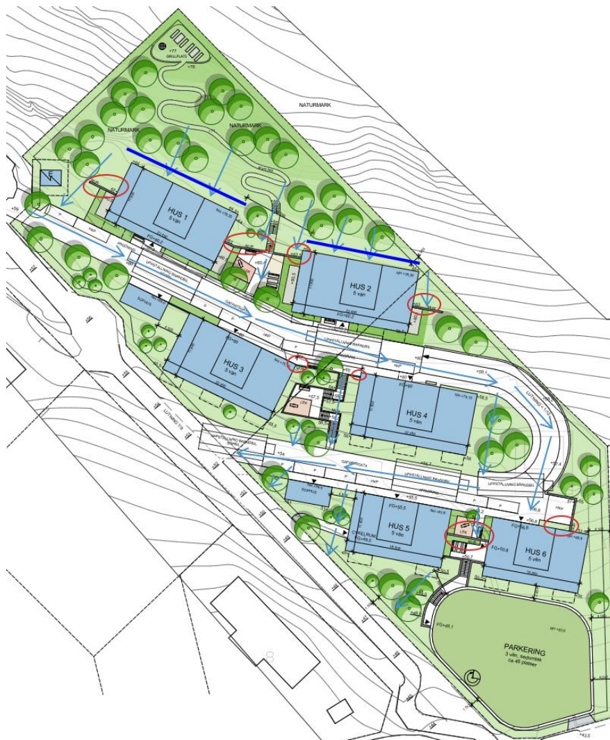
Figur 17. Situationsplan med flödesriktningar utmarkerade med blå pilar. Områden med risk för att vatten blir instängt är markerade med röda cirklar och avskärande stråk är utmarkerade med mörkblå linjer.
