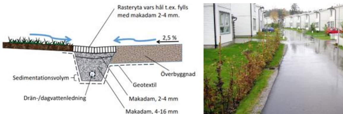
Figur 12. Principskiss på ett exempel på hur ett svackdike kan se ut (illustration WRS) till vänster. Makadamdike kombinerat med buskage inom tomtmark till höger (WRS).
