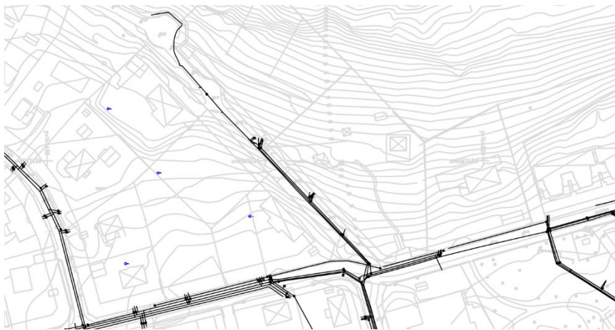
Figur 5. Befintliga VA-ledningar vid utredningsområdet. Vid platsbesök konstaterades att det finns dagvattenledningar till väster om utredningsområdet i Mellanbergsvägen och söder om utredningsområdet i Oxelvägen.
