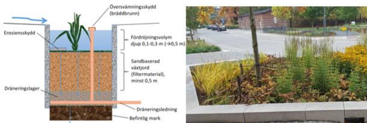
Figur 11. Principskiss för en nedsänkt växtbädd till vänster (illustration WRS). Bild på nedsänkt växtbädd omgiven av kantsten med inlopp till höger (WSP).
