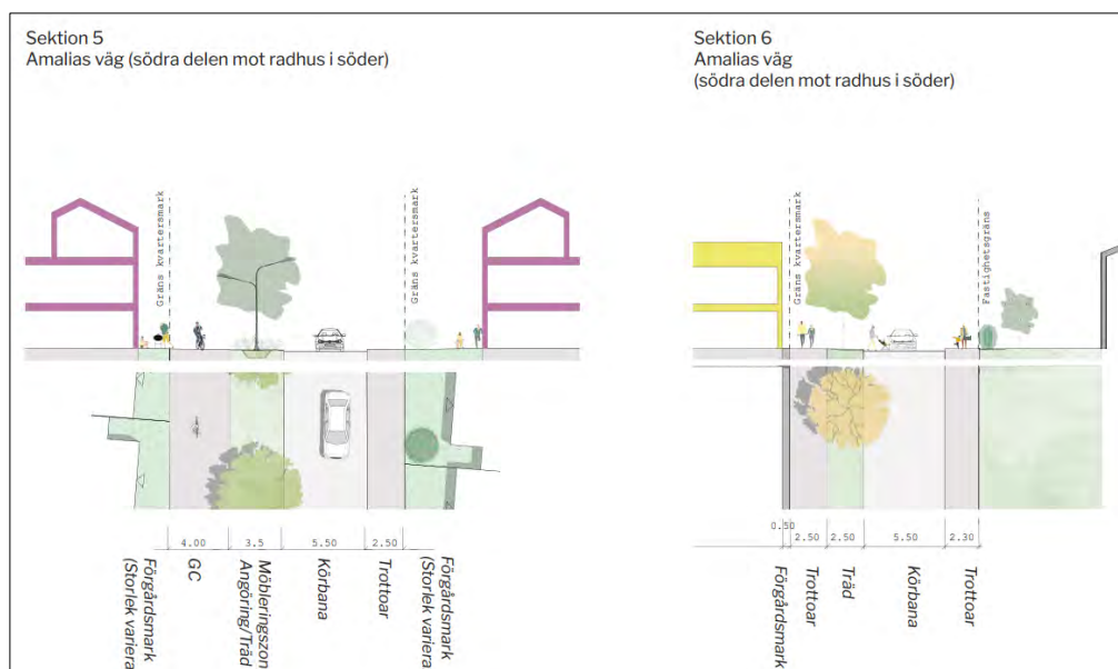
Bild 33: Gatusektioner för Amalias väg: förlängningen av gatan som kopplar ihop Amalias väg med Storskiftesvägen.
