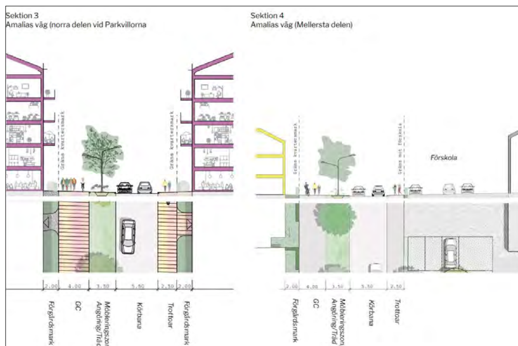
Bild 32: Gatusektioner för Amalias väg: den befintliga delen av Amalias väg som byggs om enligt sektionen ovan.
