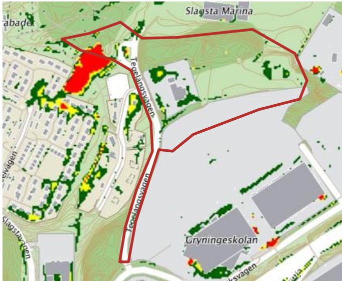
Figur 10 Skyfallskartering (utdrag ur Botkyrka kommuns webbkarta 2017-09-25) med beräknade maximala vattendjup vid 100-årsregn (rött >0,5 m, gult 0,3-0,5 m, grönt 0,1-0,3 m) och skiss över planområdesgränser i rött
