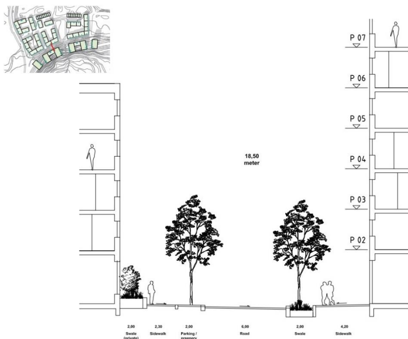
Figur 18 Förslag på gatusektion med växtbädd på fastighetsmark för takvatten, samt växtbädd/raingarden i gata för hantering av gatuvatten (C.F. Möller 2017-10-09)
