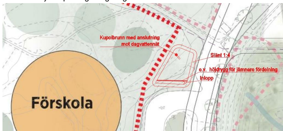
Figur 16 Alternativ för hantering av dagvatten från Tegelängsvägen.
