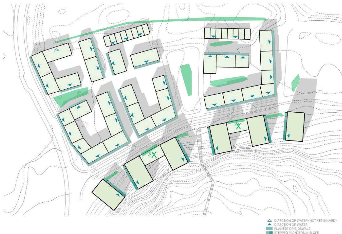
Figur 14 Fält i turkost motsvarar skiss över areor inom kvarter 1-3 avsatta för uppsamling av vatten (obs att takytor märkta med x inte ingår i dagvattenutredningen)
