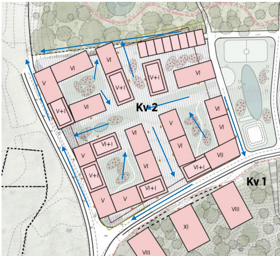
Figur 26 Förslag på ytliga avrinningsvägar kvarter 2
