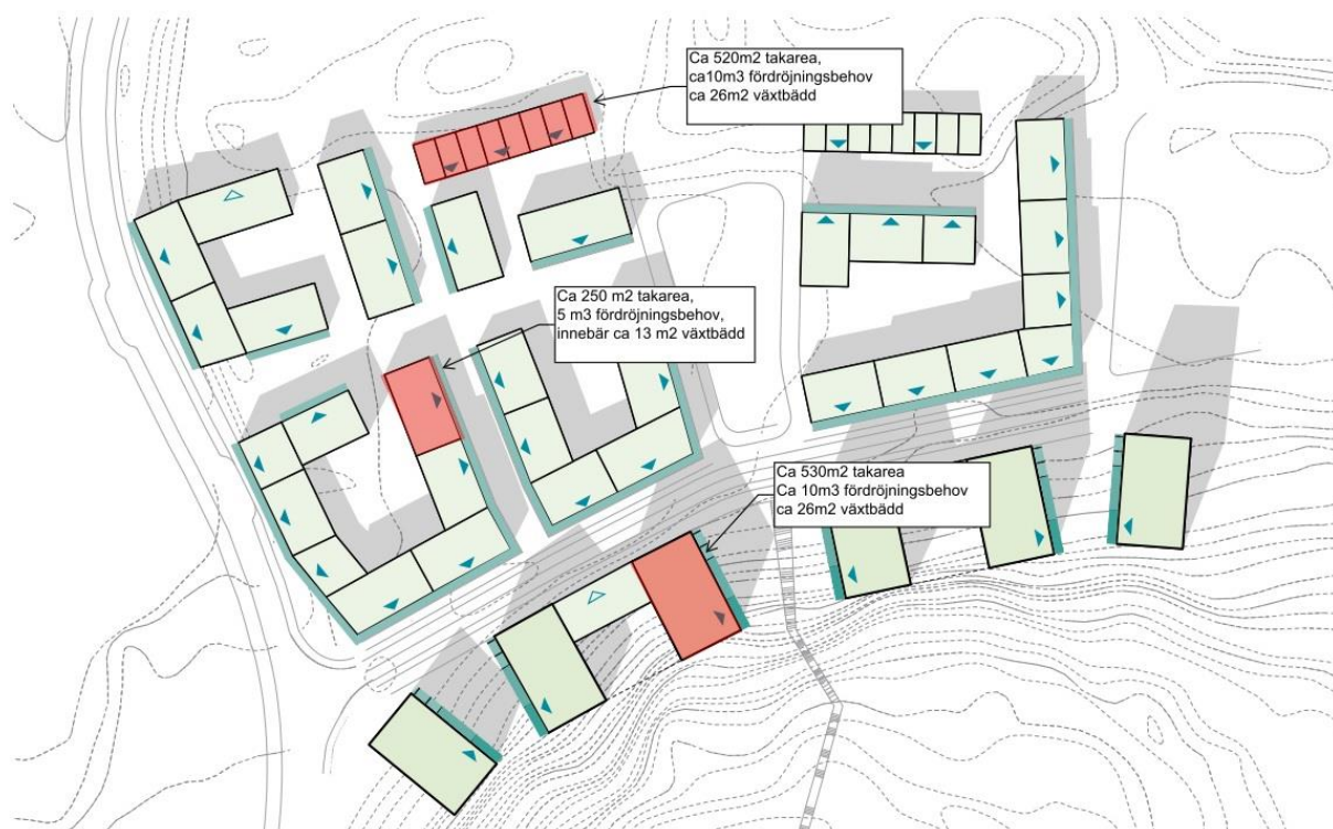
Figur 13 Typexempel på area växtbädd som motsvarar olika takareor.
