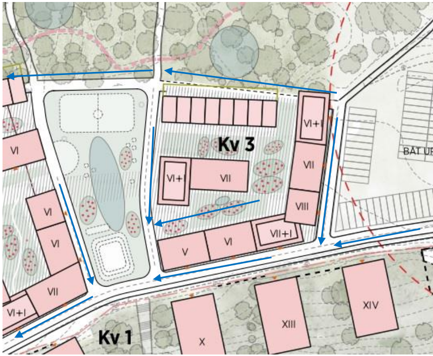
Figur 27 Förslag på ytliga avrinningsvägar kvarter 3
