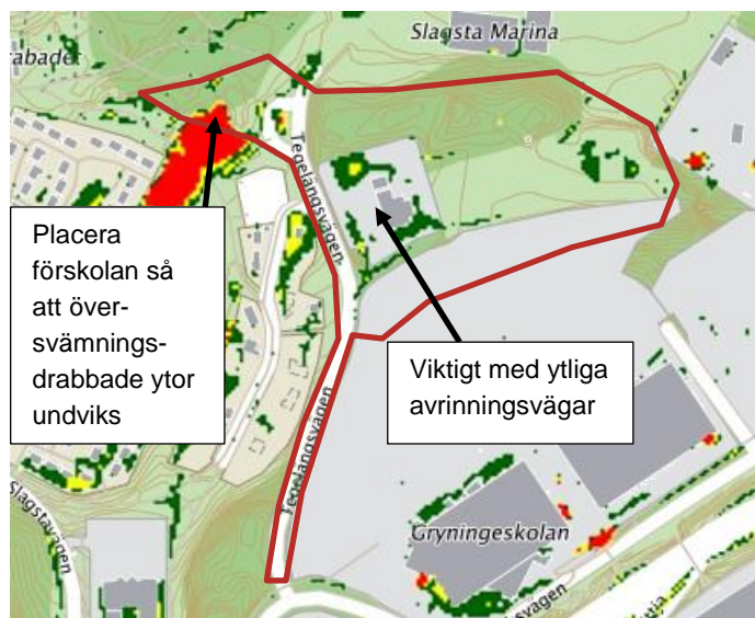
Figur 28 Skyfallskartering (utdrag ur Botkyrka kommuns webbkarta 2017-09-25) med beräknade maximala vattendjup vid 100-årsregn (rött >0,5 m, gult 0,3-0,5 m, grönt 0,1-0,3 m) och skiss över planområdesgränser i rött
