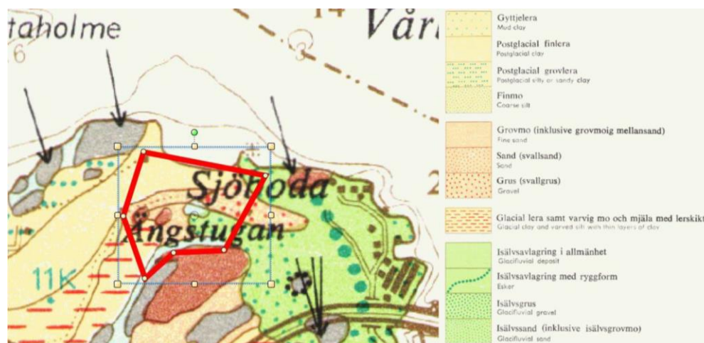
Figur 11 Geologisk karta med ungefärligt område för planerad bebyggelse. Brunt och grått är berg, blått är morän.
