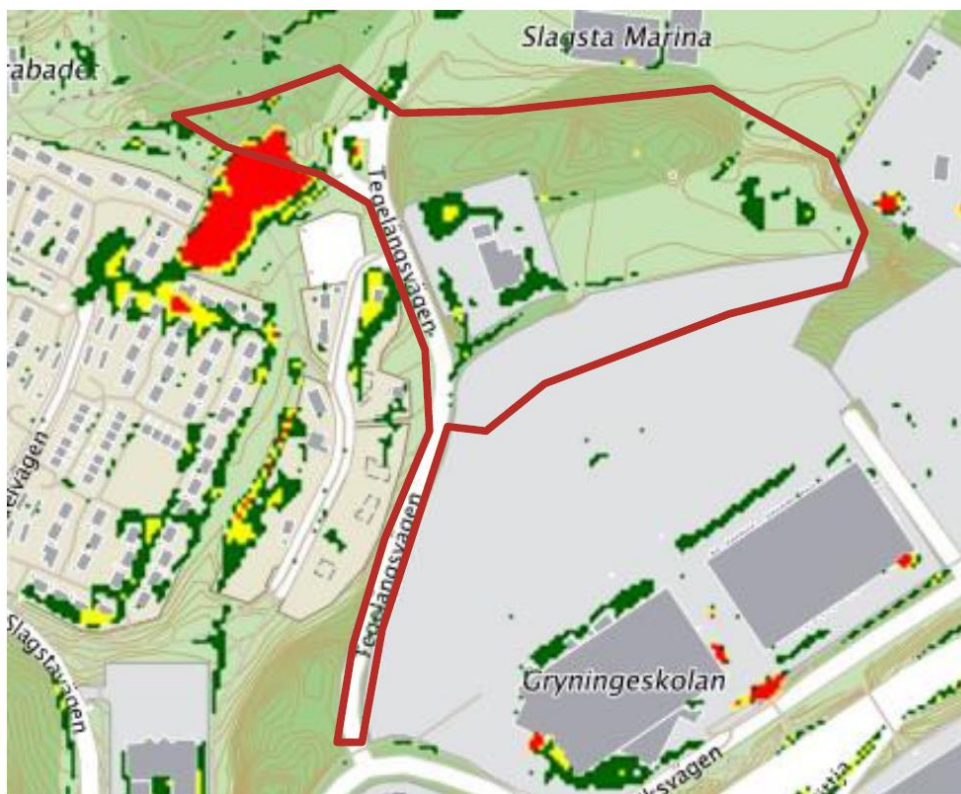
Figur 13: Skyfallskartering med beräknade maximala vattendjup vid 100-årsregn (rött >0,5 m, gult 0,3-0,5 m, grönt 0,1-0,3 m) och skiss över planområdesgränser i rött
