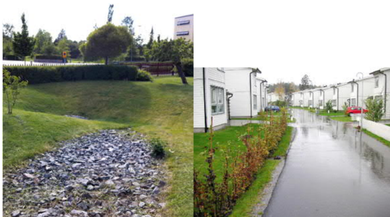
Figur 13. Principskiss för två olika typer av makadamdiken där diket till höger kombinerats med buskage. Foto WRS.
