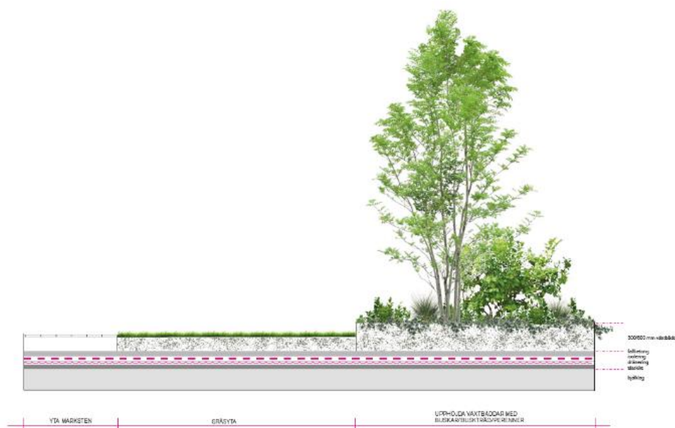
Bild överbyggnad bostadsgårdar på bjälklaget.
