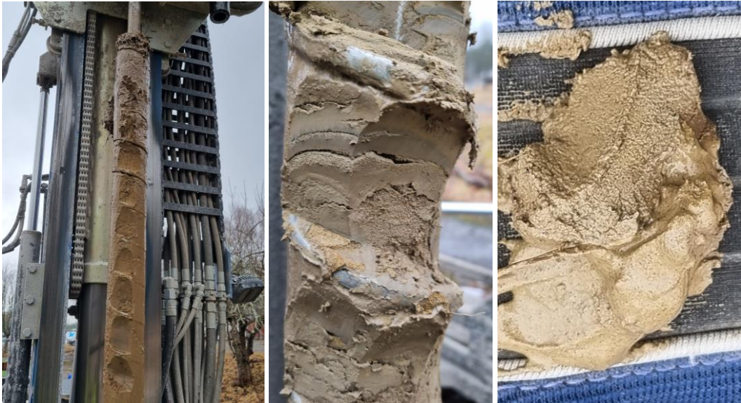
Bild 4.2 – 4.4: Bilderna visar exempel på upptagna skruvprover i punkt 7.
