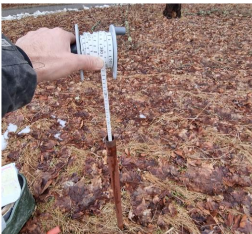
Bild 4.1.1: Bilden visar nedmätning i GW-rör i sydöstra delen av planområdet. Röret sticker upp 0,94 m över markytan och vattenytan låg 6,03 m nedan rörtopp eller 5,09 m nedan markytan, nivå ca +22,9 i RH2000, vid mätningstillfället 2023-03-20.
