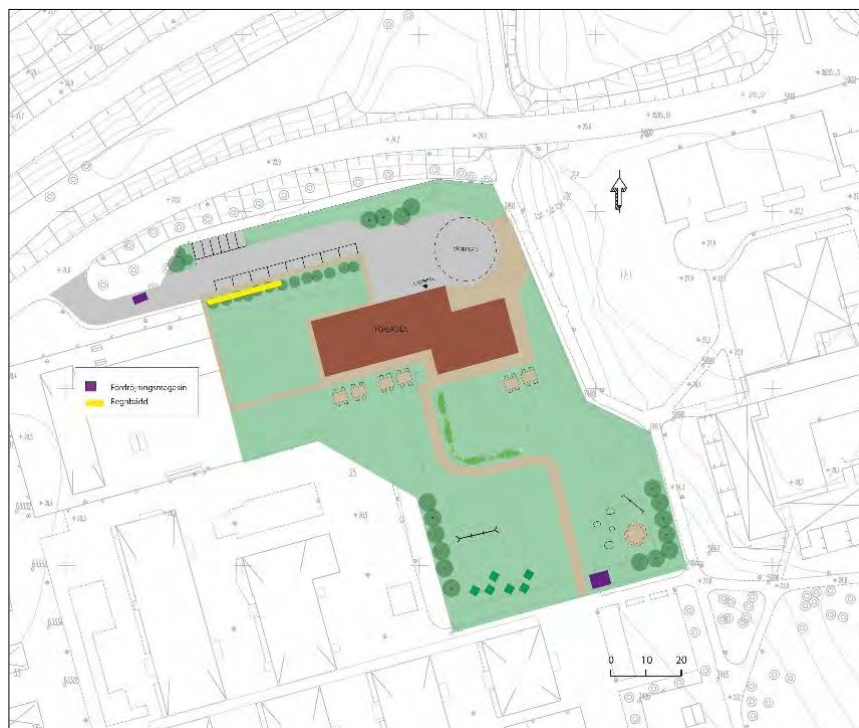
Figur 9 – Förslag på placering av dagvattenmagasin och regnbädd.
