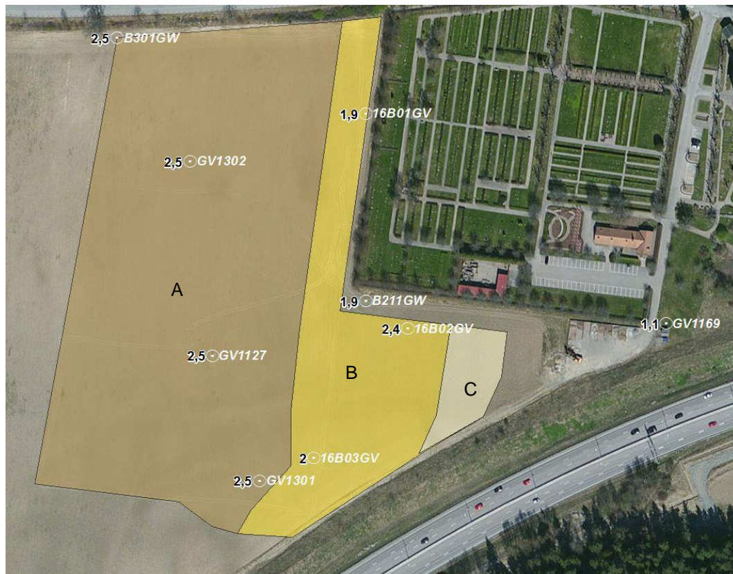
Figur 4: Maximalt tillåtna gräv djup vid respektive grundvattenrör.
