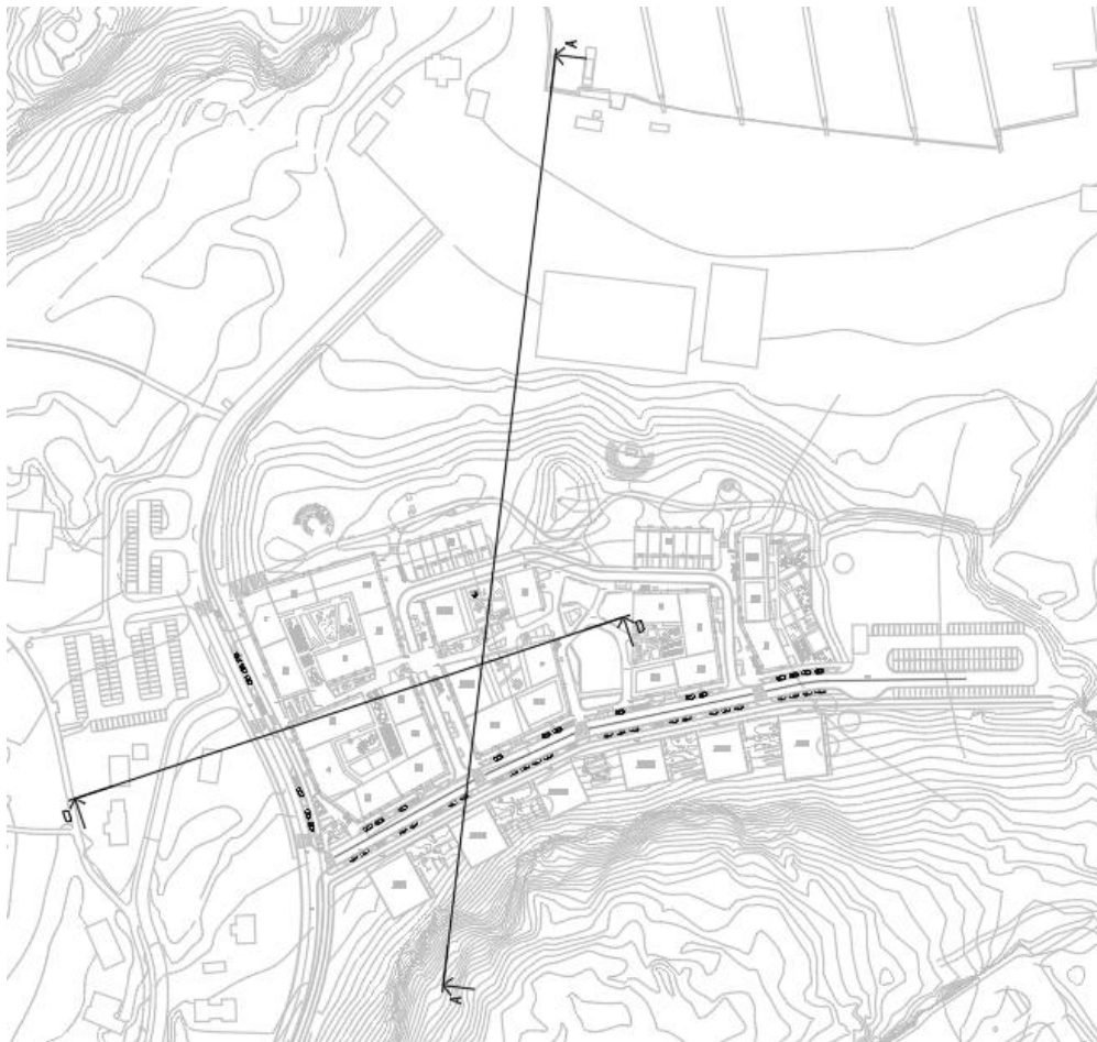
Figur 6: Sektioner var stabilitetsberäkningar är utförda i.
