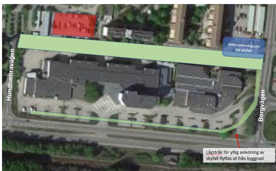
Figur 25. Förslag på åtgärder inom kvartersområde 2. Ytor markerat med rött behöver noggrant utredas ur skyfallssynpunkt i samband med eventuell förtätning/exploatering för att inte förvärra situationen för områden nedströms.
