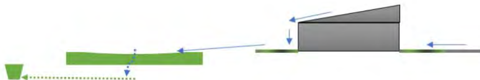
Bild 93: Principskiss för dagvattenhantering inom radhuskvarter (dagvattenutredningen, WSP 2022)
