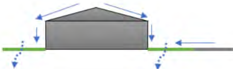
Bild 94: principskiss för dagvattenhantering i villaområdet (dagvattenutredningen, WSP 2022)
