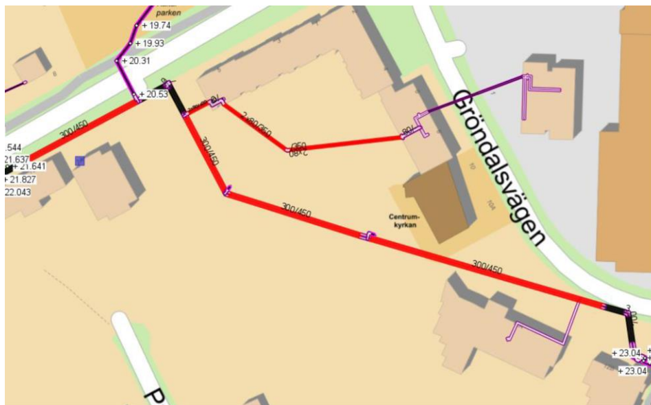
Bilaga 1 – Underlag som visar fjärrvärmeledningens placering.
