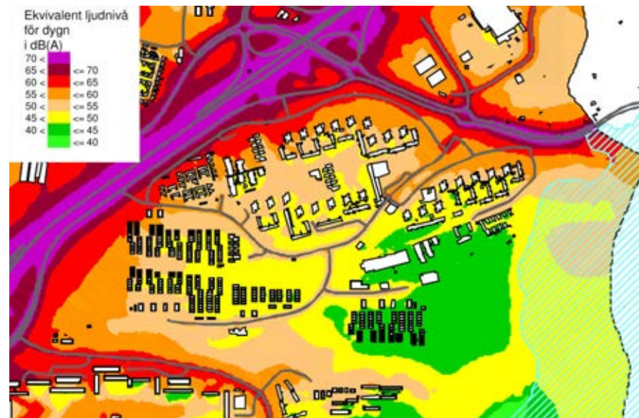
Kartan visar ett utdrag från en övergripande bullerkartering av Ingemanssons Technology AV. Orange visar de områden som det den ekvivalenta ljudnivån är 55 dB(A). Den blå skrafferingen motsvarar Albysjön.
