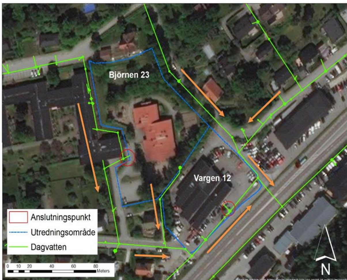
Figur 3. Befintligt dagvattensystem inom och runt utredningsområdet (Botkyrka kommun, 2022-06-27) 7 . Pilar visar flödesriktning i ledningar (Bild: Tyrens rapport 2019-04-29).
