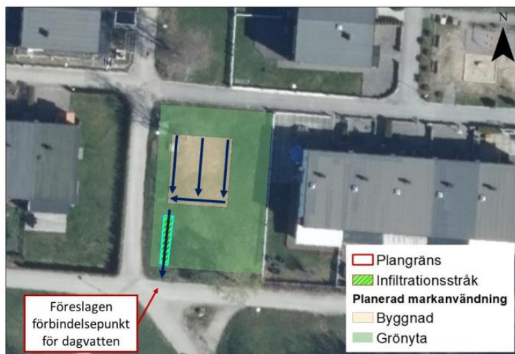
Bild 11: Lämplig läge för infiltrationsstråk och föreslagen förbindelsepunkt till kommunens dagvattenledningar.
