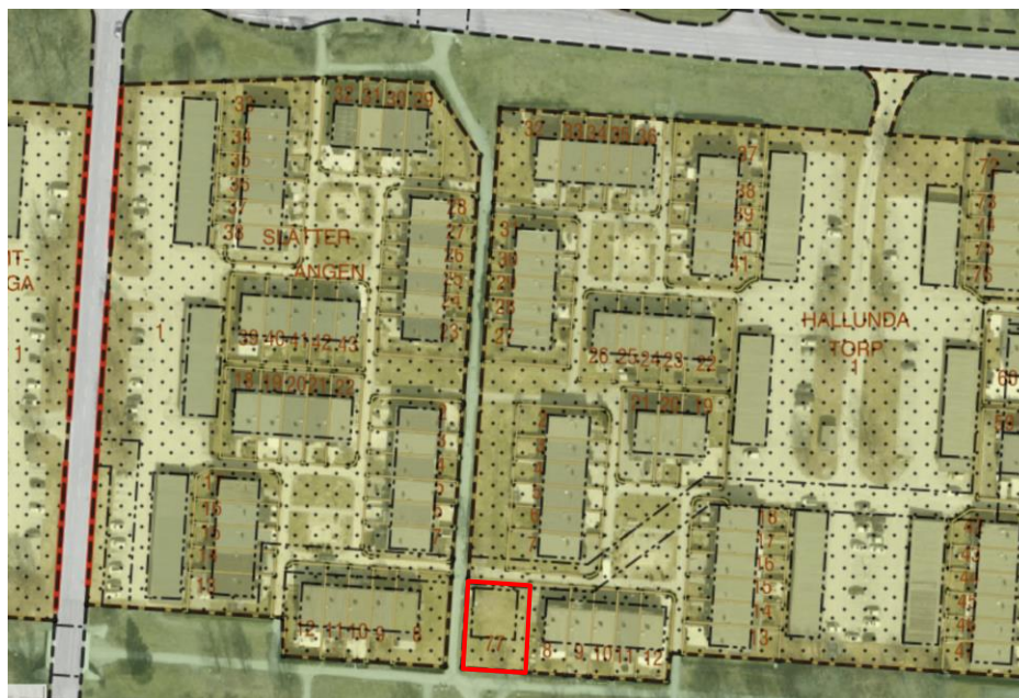
Bild 3: Tolkad planmosaik på kommunens ortofoto. Fastigheten Hallunda torp markerad med rött. Den prickade marken representerar marken som inte får bebyggas och rektanglar ritade med punktprickade linjer visar byggrätter enligt gällande detaljplan
