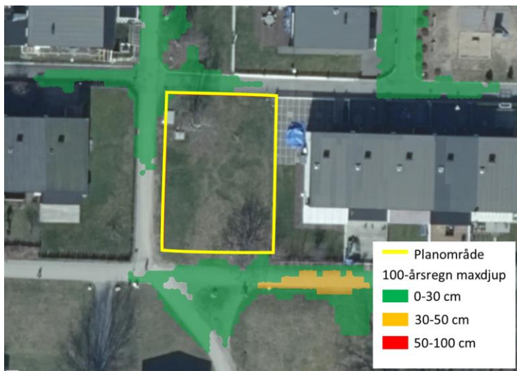
Figur 11: Maximala vattennivåer vid ett 100-årsregn med klimatfaktor 1,25 (SCALGO Live, 2023).
