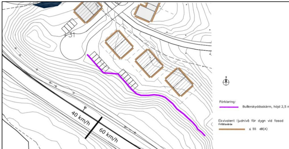
Urklipp från bullerutredningen: Ekvivalent ljudnivå för dygn vid fasad efter uppförandet av bullerskärm på den delen av planområdet som påverkas mest av vägbullret från väg 225.
