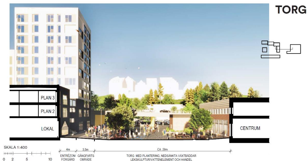
Figur 6: Sektion som visar hur torget är tänkt att fungera. Den nya bebyggelsen syns till vänster, och centrumbyggnaden till höger. Mellan dem går gångfartsområdet och torget. Total arkitekter 2022.
