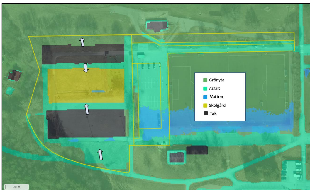
Figur 7-1: Skyfallsanalys vid 100-årsregn motsvarande 50 mm regn. Vattensamlingar med ett vattendjup större än 10 cm visas i blå. Avrinningsriktning motsvarar ljusblå pilar.
